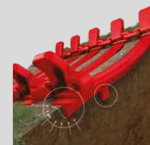
Le but de l'utilisation des chenilles est de réduire la pression sur le sol et d'empêcher le glissement. Le graphique à gauche montre la combinaison de TXL, à droite celle des GL84 avec le sol.
